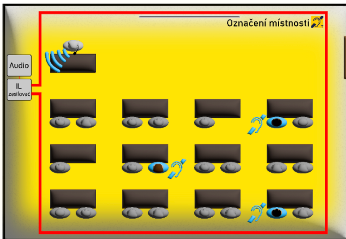
Obr. 18: Instalace IL smyčky po obvodu místnosti je častá, ale možná pouze v menších prostorách a tam kde není přítomna žádná kovová konstrukce, kde by mohlo docházet ke ztrátám signálu
