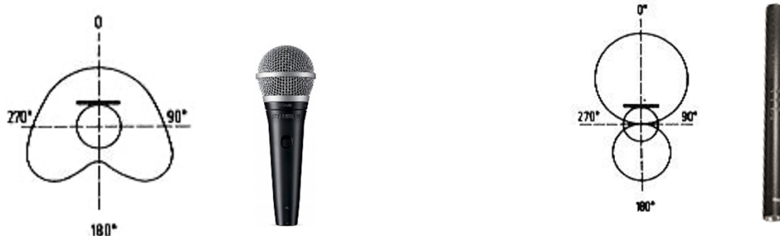
Obr. 36: Mikrofon kardioida a obr. 37: Mikrofon hyperkardioida
