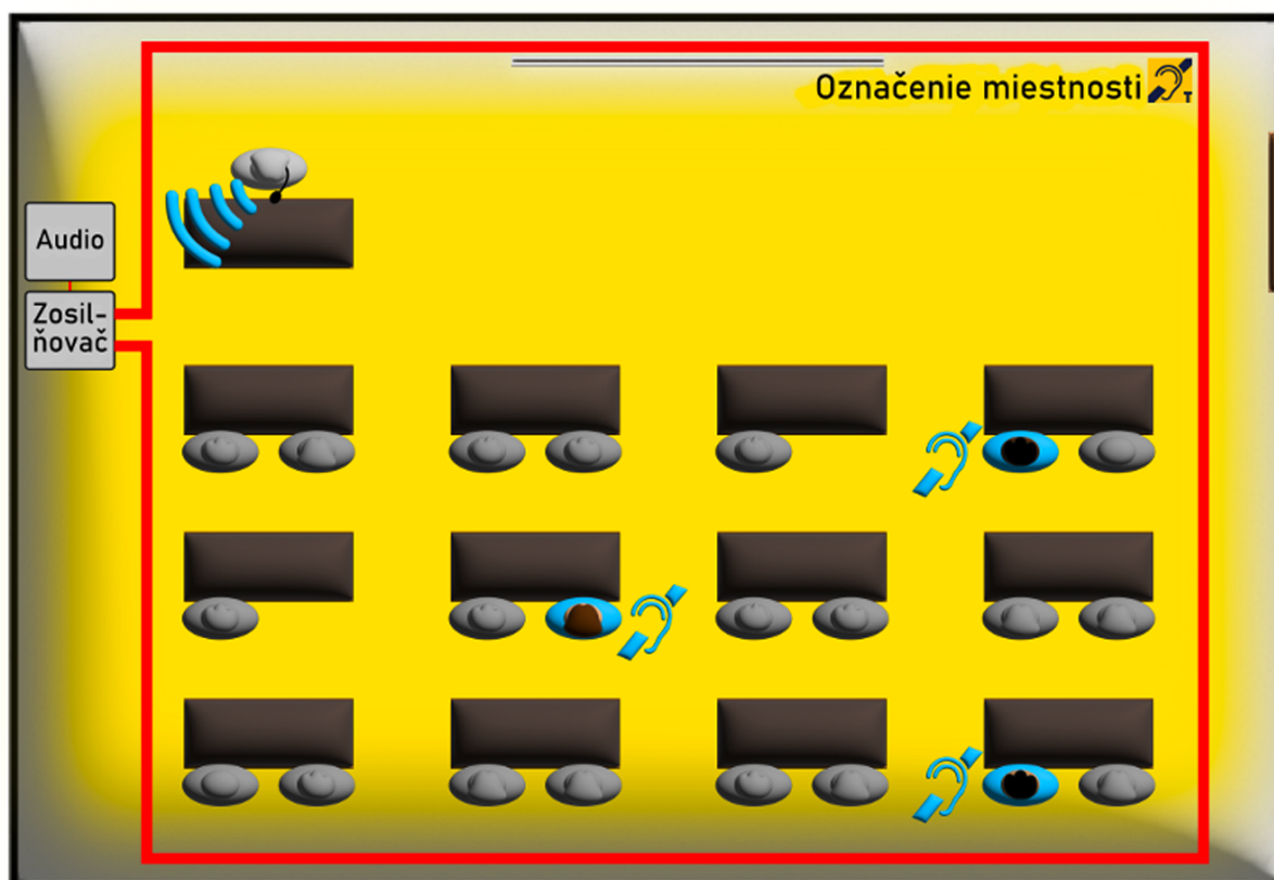
Obr. 18: Inštalácia IL sučky po obvode miestnosti je častá, ale možná iba v menších priestoroch a tam kde nie je prítomná žiadna kovová konštrukcia, kde by mohlo dochádzať k stratám signálu
