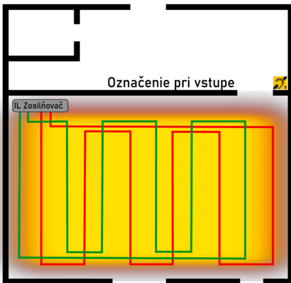
Obr. 10: Dvojitá (viacslučková) prekladaná indukčná slučka pre menšie miestnosti a ľahké ovládanie presahu signálu do vedľajšej miestnosti
