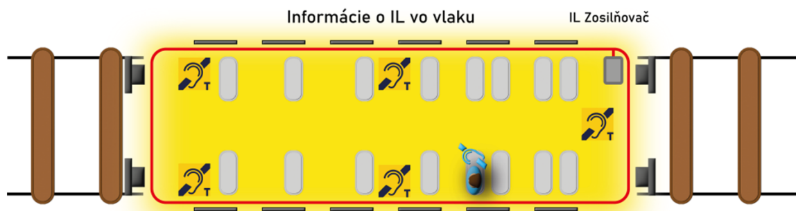
Obr. 26: IL vo vozni – obvodová slučka ve stropnej konštrukcii vozňa – informácie o IL ve voze
