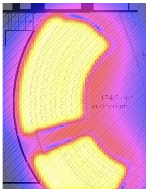
Návrh zapojenia a vizualizácie signálu IL v Auditóriu centra architektúry a Mestského plánovania v Prahe
