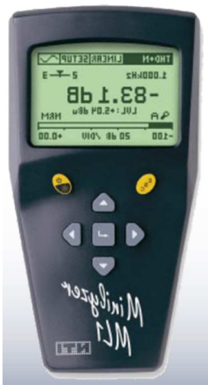
Obr. 12: Minilyzer ML1 NTI – slučkový prijímač + merač všetkých základných parametrov IL
